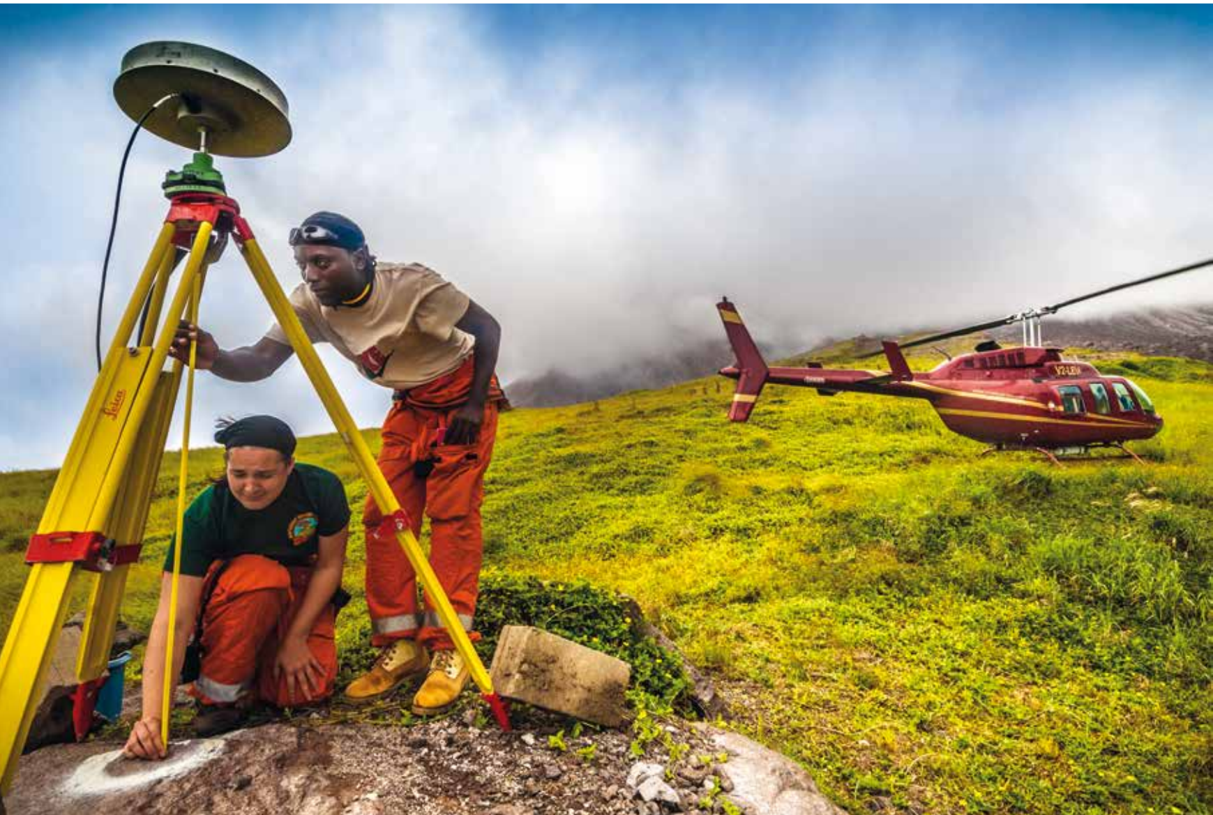
Karen Pascal et Tappy Sayers se font hélicopter sur le flanc du volcan pour installer une mesure de point GPS temporaire. Les instruments sont laissés une semaine avant le prochain relevé, les données étant stockées dans un disque dur sur place. Les rotations sont assurées une fois par semaine par une compagnie basée à Antigua.
